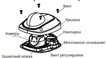
Рисунок 1-23 Настройка угла наблюдения камеры
